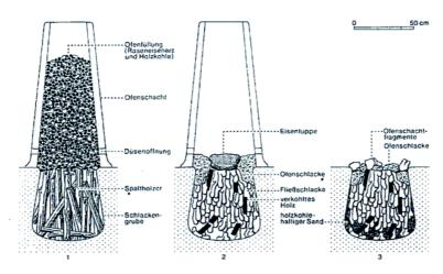
1 Rennfeuerofen vor dem Betrieb; 2 Rennfeuerofen nach Beendigung des Verhüttungsprozesses; 3 Überrest eines Rennfeuerofens nach Entnahme der Luppe (nach Backer u.a.), wie er im archäologischen Befund nachzuweisen ist.
